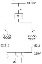
A potência de cada transformador é de 300kVA e a sua impedância é de 3,80% sob 13,8kV. A concessionária local informa que a corrente de curto-circuito trifásico, na entrada do ramal, é de 4760 A.
